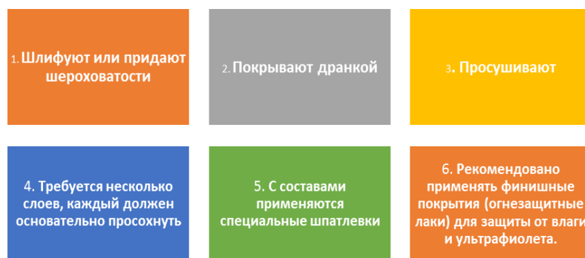
Рис. 3 Способ нанесения антипиренов
