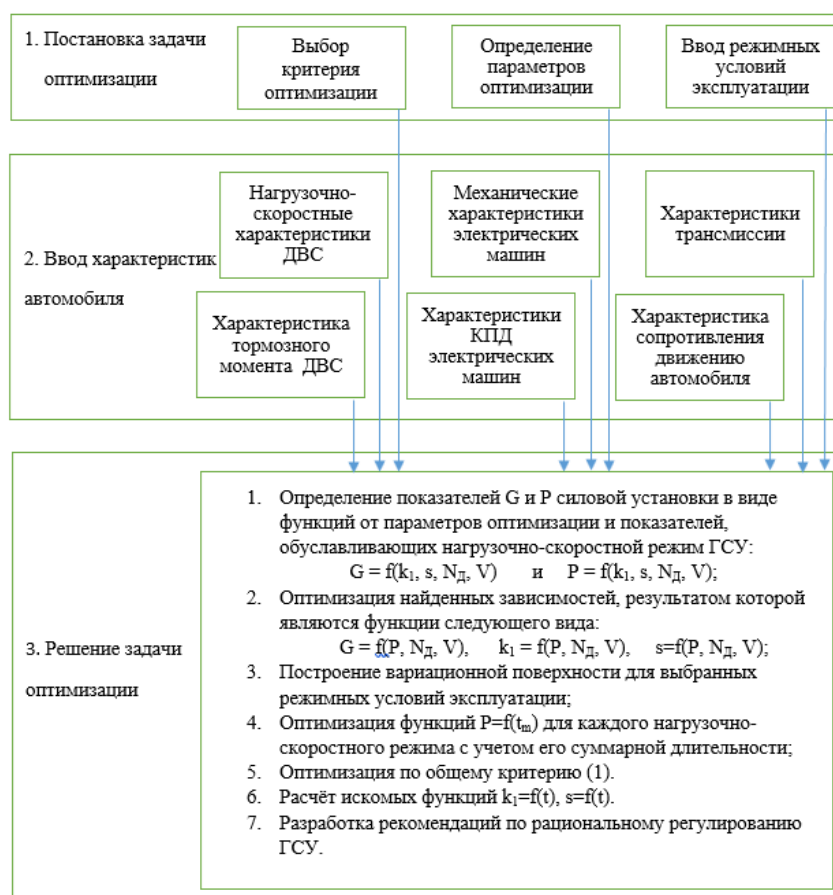
Рис. 1. Алгоритм поиска рационального значения оптимизационных параметров: k_1 и s – выбранные независимые режимные параметры ГСУ для Toyota Prius – коэффициент использования мощности первой электрической машины и относительная частота вращения коленчатого вала ДВС
