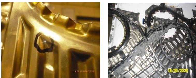
Рис. 2. Повреждение пластинчатого теплообменника
