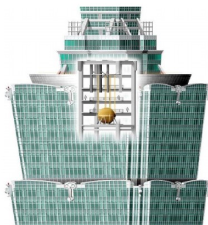
Рис. 1. Инерционный демпфер на высотном здании Тайбэй 101
